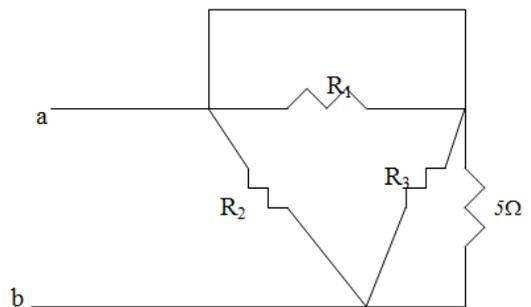
$$R_1 // 0 = 0, \quad R_3 // 5 = 40 // 5 = 4.444 \Omega$$
